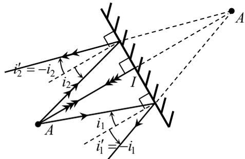
Pour un point objet  $A$  réel (faisceau incident divergent), comme ci-dessus, l'image  $A'$  est l'intersection des *prolongements* des rayons réfléchis (faisceau réfléchi divergent également), donc  $A'$  est un point image *virtuel*. Effectivement, quand on se regarde dans une glace, notre image est virtuelle : si on mettait un écran là où semble se trouver notre image, c'est-à-dire derrière le mur où est fixé le miroir, on ne verrait rien sur l'écran !
