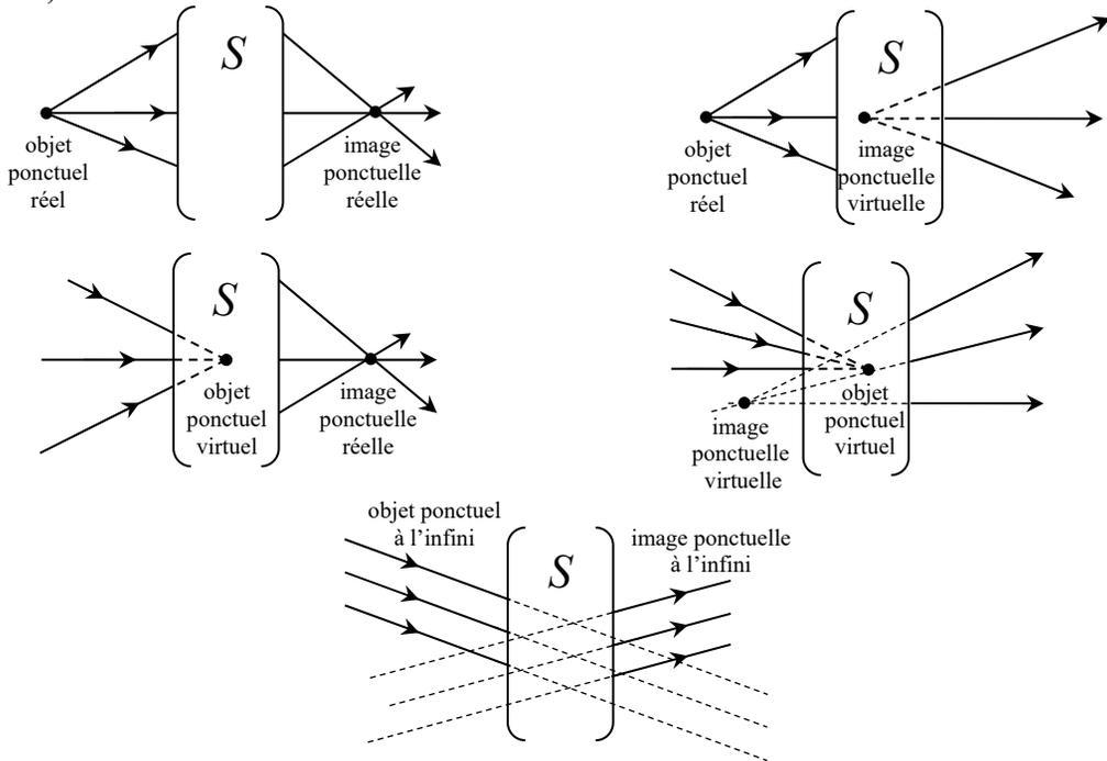
Un objet réel se trouve donc du côté de la lumière incidente, avant la face d'entrée du système, contrairement à un objet virtuel. Une image réelle se trouve du côté de la lumière émergente, après la face de sortie du système, contrairement à une image virtuelle.
