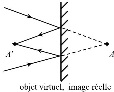
⇒ **Méthode 1.4. Déterminer l'image d'un objet par un miroir plan**
