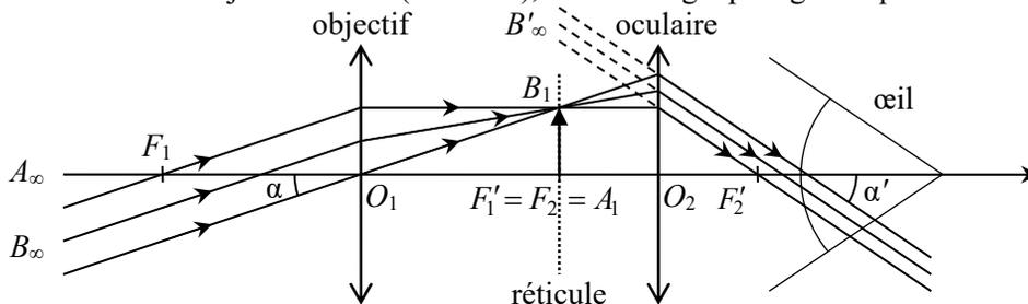
L'objectif donne de l'objet  $AB$  une image intermédiaire  $A_1 B_1$  (renversée), qui doit se former sur le réticule : celui-ci doit donc se trouver en  $F'_1$ .
