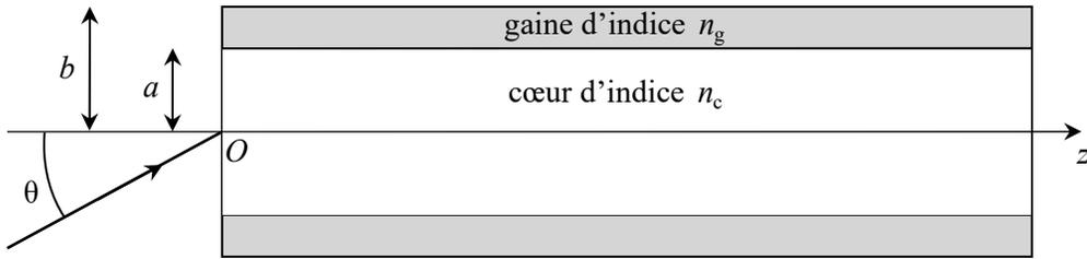
1. Déterminer la valeur maximale admissible  $\theta_a$  de l'angle  $\theta$  pour que le rayon puisse être guidé dans la fibre, et calculer l'ouverture numérique  $o_n = n_0 \sin \theta_a$ .
