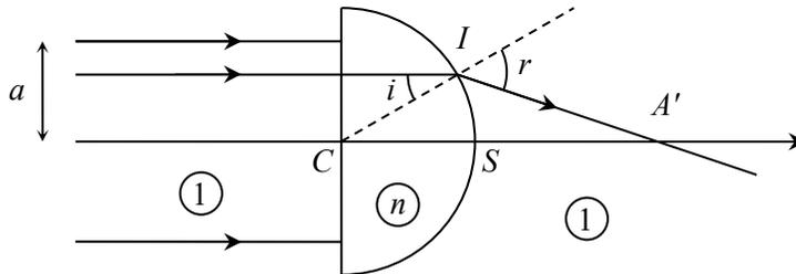
2. En déduire la limite  $CF'$  de  $CA'$  lorsqu'on se place dans l'approximation de Gauss (à définir). Quelle propriété de la lentille obtient-on ? Que représente le point  $F'$  ?
