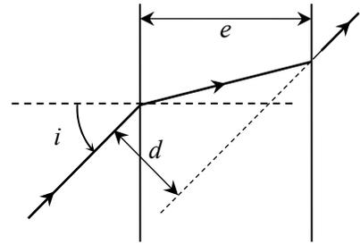
1. Déterminer l'écart  $d$  entre le rayon incident et le rayon émergent en fonction de  $n$  et  $\sin i$ .
