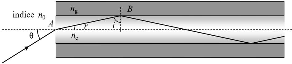
– Au point  $B$ , comme  $n_c > n_g$ , la condition de réflexion totale s'écrit :  $\sin i > \sin i_{\text{lim}} = \frac{n_g}{n_c}$  (1).
