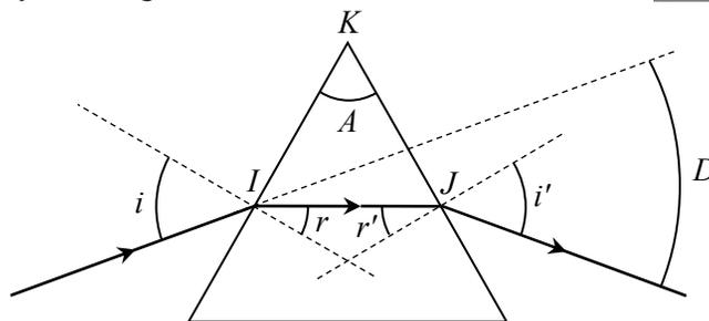
1. Appliquer la loi de Snell–Descartes en  $I$  et  $J$ . Établir également les deux relations géométriques :  $A = r + r'$  et  $D = i + i' - A$ . (Ces quatre relations sont les *formules du prisme*.)
